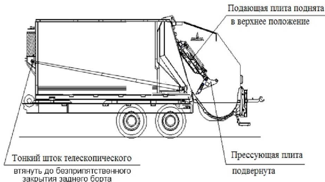
Рисунок 5.1.1 – Исходное положение прессующего механизма и выталкивающей плиты перед началом загрузки
